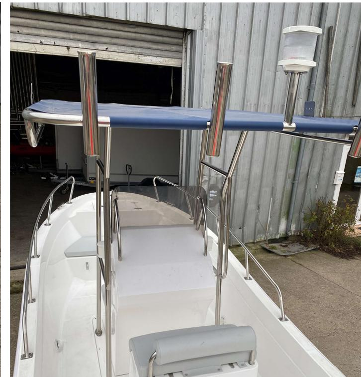
Oberhalb der Steuerkonsole ist ein ideal dimensioniertes T-Top, das ausreichend Sonnenschutz liefert. Es kann auf Wunsch mit bis zu vier Rutenhalten und einem BSH Toplicht ausgestattet werden.
