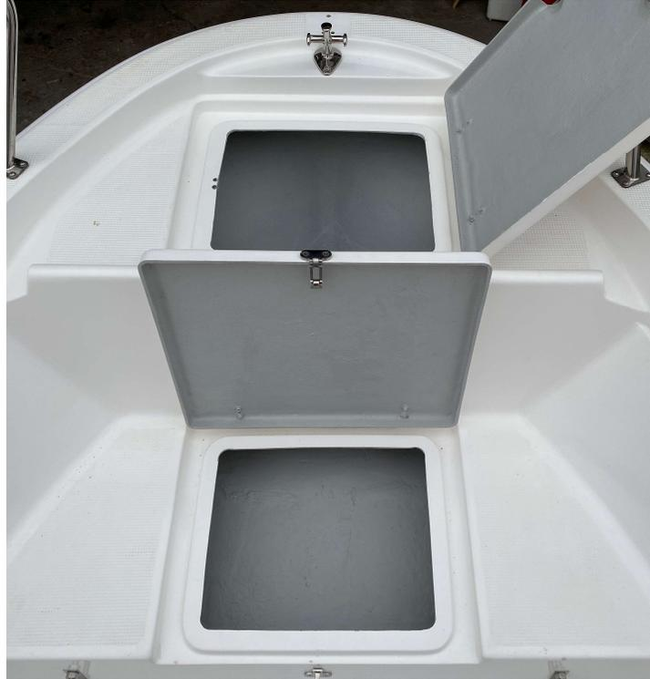
Der Ankerkasten besitzt ein Lenzloch nach Aussenbords, damit das Stauwasser abtropfen kann. Unter der Sitzfläche befindet sich weitere Staumöglichkeiten für Equipment.
