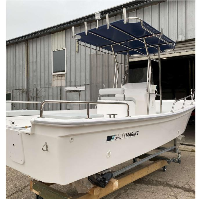
Die Heckrailing und der Bugkorb sowie das T-Top sind aus massivem, rostfreiem V4A Marinstahl gefertigt und geben der SALTY 580 Sicherheit und Festhaltungsmöglichkeiten.
