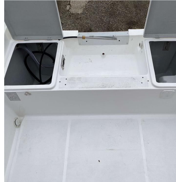
Mittig am Heck befindet sich der stabile Spiegel, der das Fundament für den Aussenborder darstellt. Ebenfalls finden sich auf der Steuer- und Backbordseite Backskisten für diverses Zubehör wie: Batterie, Lenzpumpe, etc.
